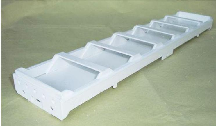
Die Verstärkung des Pufferbohls wird an die Unterseite geklebt. Auch ein Winkelprofil (3 x 3 mm) an die Wagenseite, entlang der Bodenplatte.
