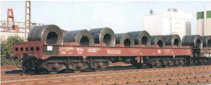
Sieben Lademulden sind dabei integriert in den Wagenboden, wobei jede Mulde am Oben eines Wagenrechtes Teil hat, so dass auch flache Stahlbrammen können transportiert werden.
