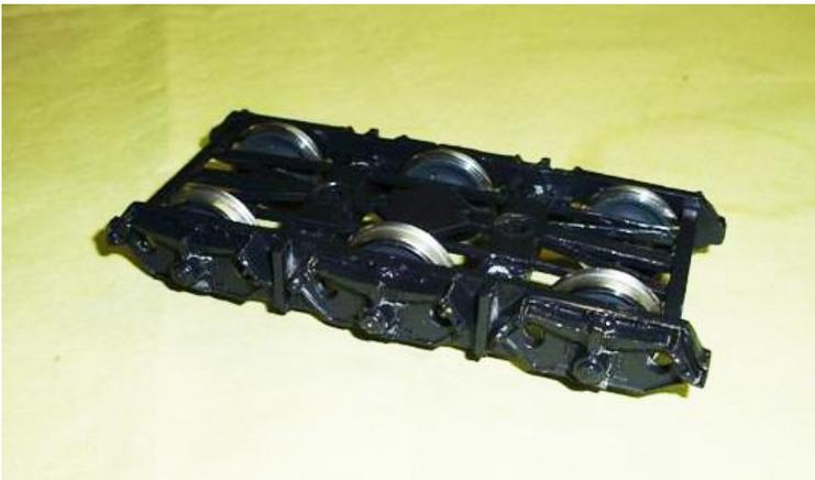
Nach der Montage von den beiden Drehgestellen ist das Coilwagen Modell Gattung Sahnms 711 fertig gestellt.
