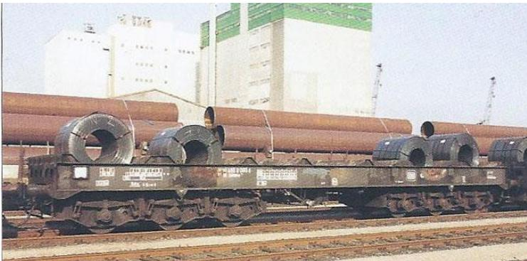
Die Ursprüngliche 150 Wagen sind gebaut worden mit Drehgestelle Bauart 711, aber Weitere 200 Wagen (1987) hatten BA713 und die letzt gebaute Wagen (1993) hatten BA714 Drehgestelle, weil das Gehäuse von die drei Bau löse nur in kleine Details Unterschiedlich war. Teilweise sind diese Wagen verkauft und vermietet an Privat Geschäfte.
